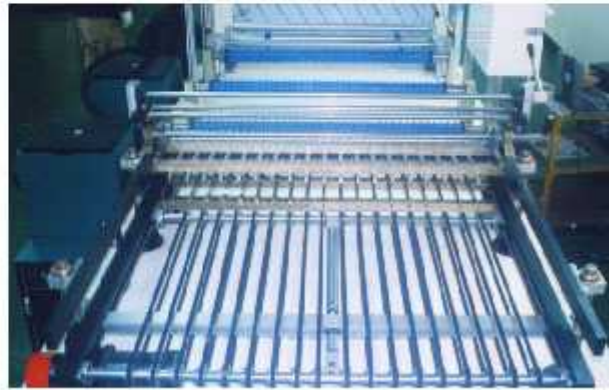
滤材折叠成形后采用输送系统输出
