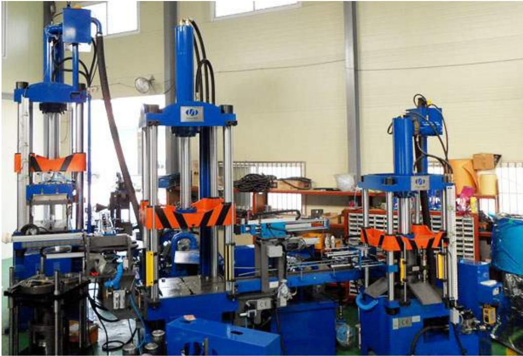
机油滤外壳液压拉伸机：60吨为主机拉伸 + 30吨拉伸 + 30吨冲边
