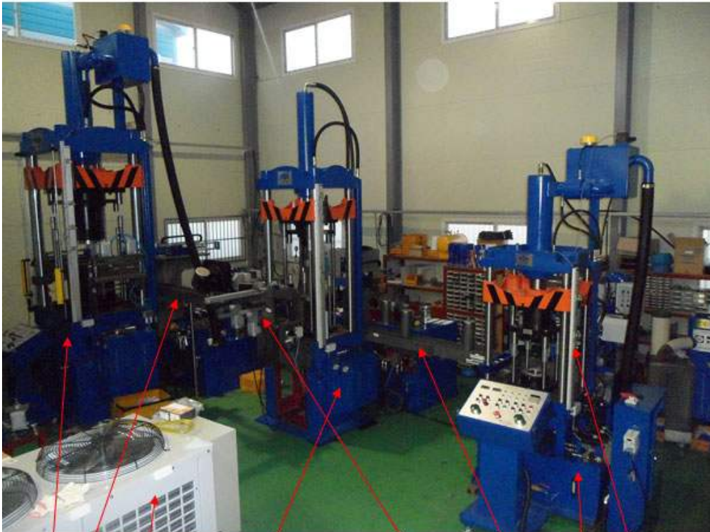
机油滤外壳液压拉伸机：60吨为主机拉伸 + 30吨拉伸 + 30吨冲边
