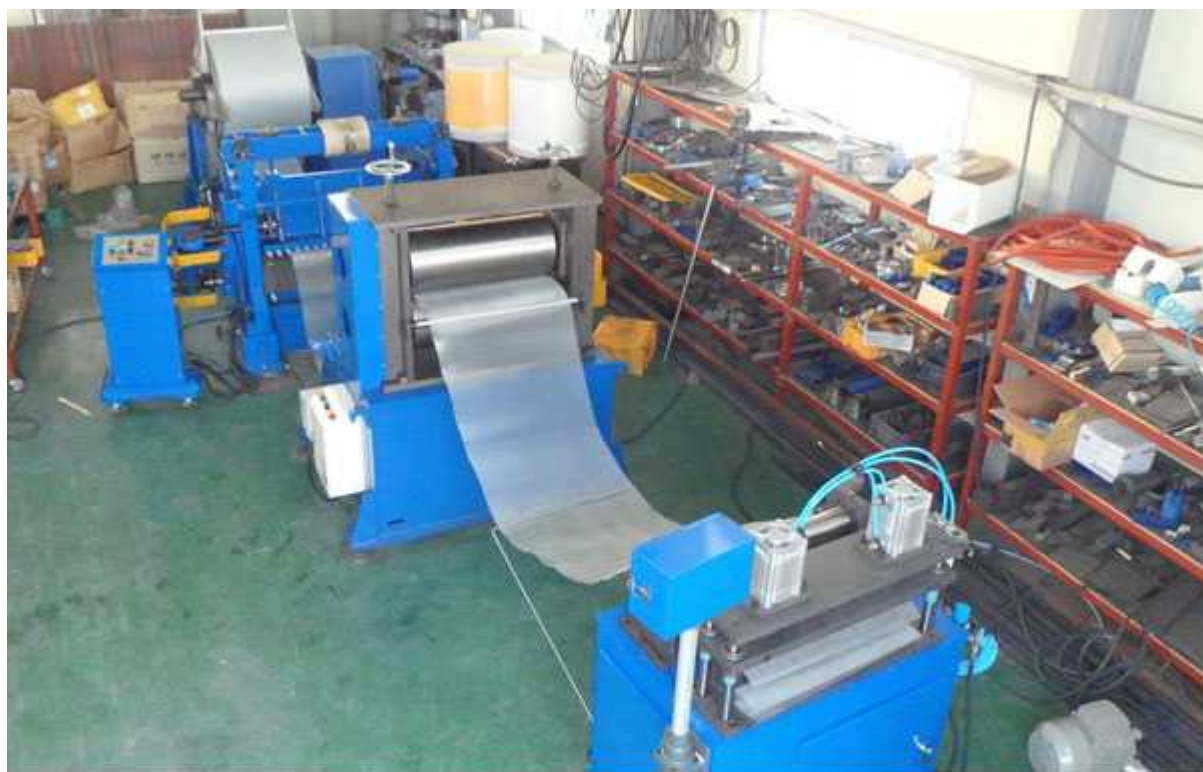
拉网、压平、自动剪切连线
