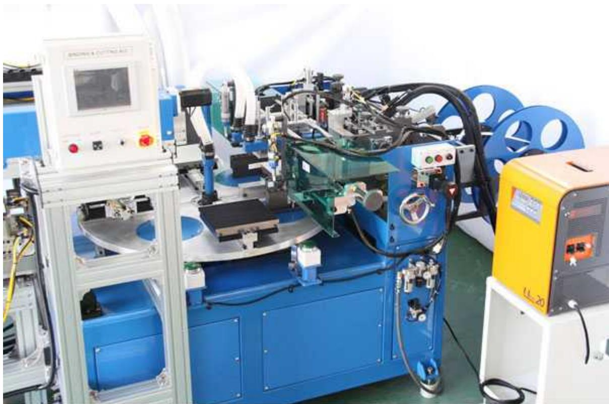
主机旋转系统、滤纸夹具、及贴边料送料架
